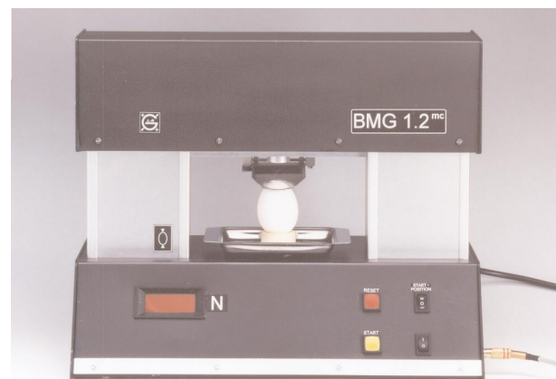
Abbildung 1: Gerät zur Bestimmung der Bruchfestigkeit
